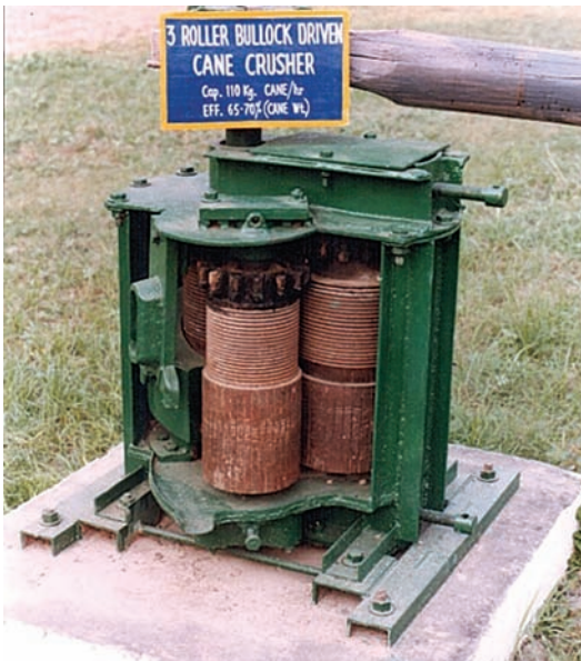
चित्र 3: बैल चालित तीन रोलर गन्ने का कोल्हू
