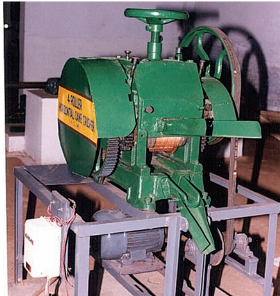
चित्र 4: बैल चालित चार रोलर गन्ने का कोल्हू
